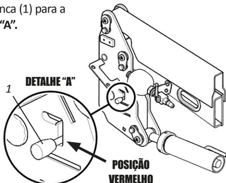
Depois de ajustar a alavanca (1) na posição “vermelho”, faça a fixação do suporte móvel (2) na armação lateral (3), utilizando ponte, guincho ou o próprio hidráulico da PAMP-ER 6. Ao utilizar ponte ou guincho, faça primeiro o alojamento do pino menor (4) na concavidade “A” do chassi lateral (5). Em seguida, faça o alojamento do pino maior (6) na concavidade “B” do chassi lateral (5), travando o suporte móvel (2).
