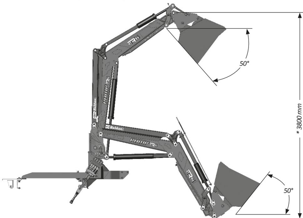
*(\*) A altura de levante da PAMP-ER 6 pode ter pequenas variações de trator para trator devido ao modelo de pneu e altura do bloco do trator em relação ao solo.*
