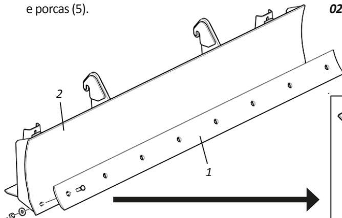
**02** - Em seguida, substitua a faca (1) e fixe-a novamente com os parafusos (3), arruelas lisa (4) e porcas (5).
