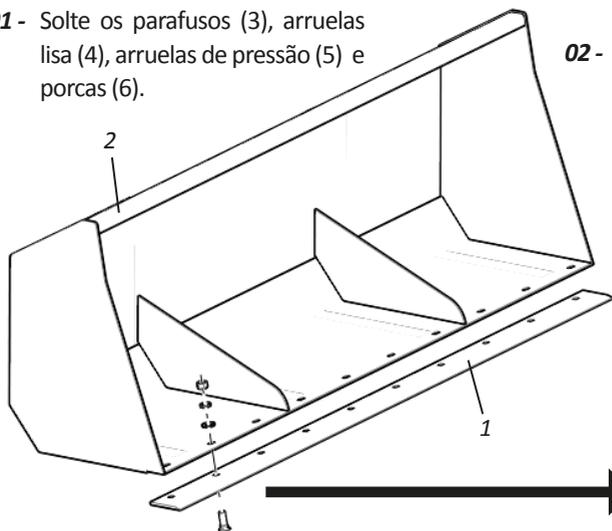
**02** - Em seguida, substitua a faca (1) e fixe-a novamente com os parafusos (3), arruelas lisa (4), arruelas de pressão (5) e porcas (6).
