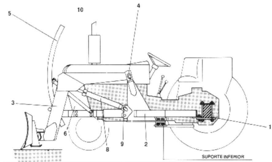
Montagem da plaina com suporte vertical (1) e suporte inferior das armações montado na carcaça do trator e no eixo traseiro do trator.
