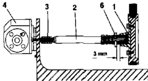
*Acoplamento da bomba na carcaça do trator. (Não usa suporte da bomba).*
