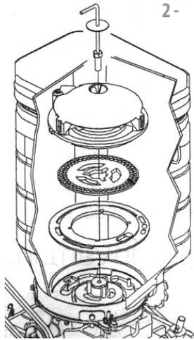
2- Escolha o disco distribuidor desejado e proceda a montagem do mesmo na caixa de sementes. Verifique a colocação dos anéis conforme o disco distribuidor de semente da seguinte forma:
