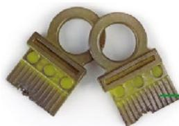
**Poliflow** com desgaste, necessidade de troca.
