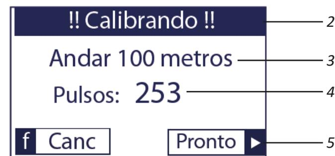
Ao iniciar a calibração do sensor (2), a máquina deve ser deslocada por exatos 100 metros (3) e parar.
