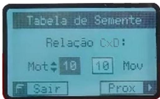
14) Em seguida, mantenha a quantidade de furos colocado anteriormente e clique em próximo.
