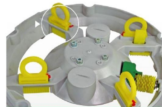
**Poliflow** com desgaste, necessidade de troca.
