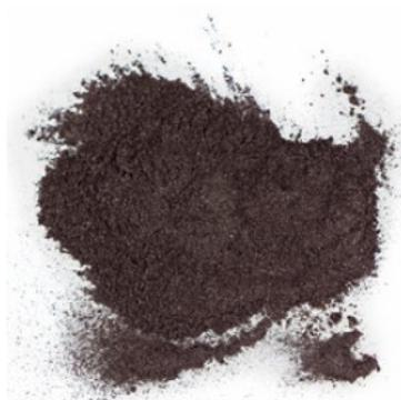
O uso do grafite é fundamental para o funcionamento do sistema e também para perfeita distribuição das sementes, reduzindo duplos e falhas, sementes quebradas e desgastes do sistema.
