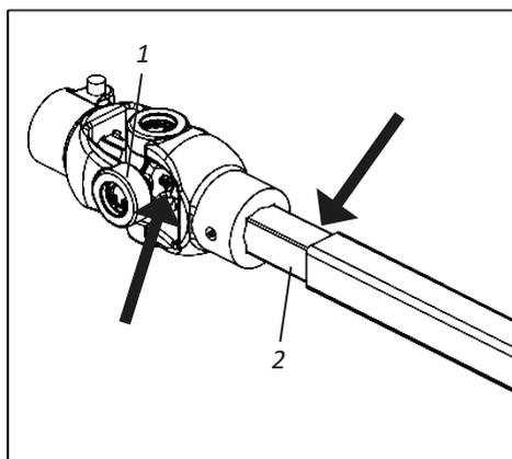
Lubrificar as cruzetas (1) com graxa em intervalos de 8 horas. O eixo telescópico (2) deverá ser lubrificado semanalmente.
