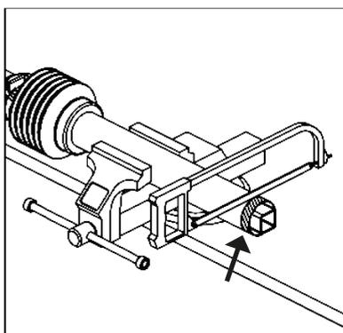
Diminua os tubos protetores interno e externo do cardan proporcionalmente.
