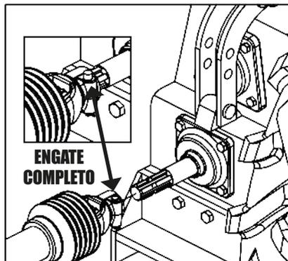
Aople a flange no eixo da TDP do trator observando que o engate só se completará quando a trava (1) saltar.
