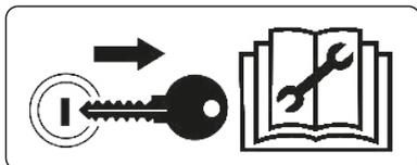
Retire a chave de ignição antes de realizar qualquer tipo de manutenção na RPDL.
