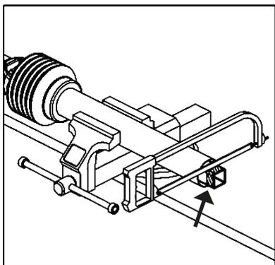
Corte as barras internas do cardan no mesmo comprimento dos tubos protetores.
