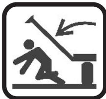
*Evite acidentes provocados pela ação intermitente dos marcadores de linha. Ao acionar o sulcador, observe se não há pessoas sob marcadores de linha ou na área de ação dos mesmos.*
