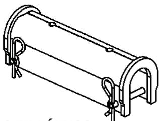
**TRAVA DO CILINDRO HIDRÁULICO
