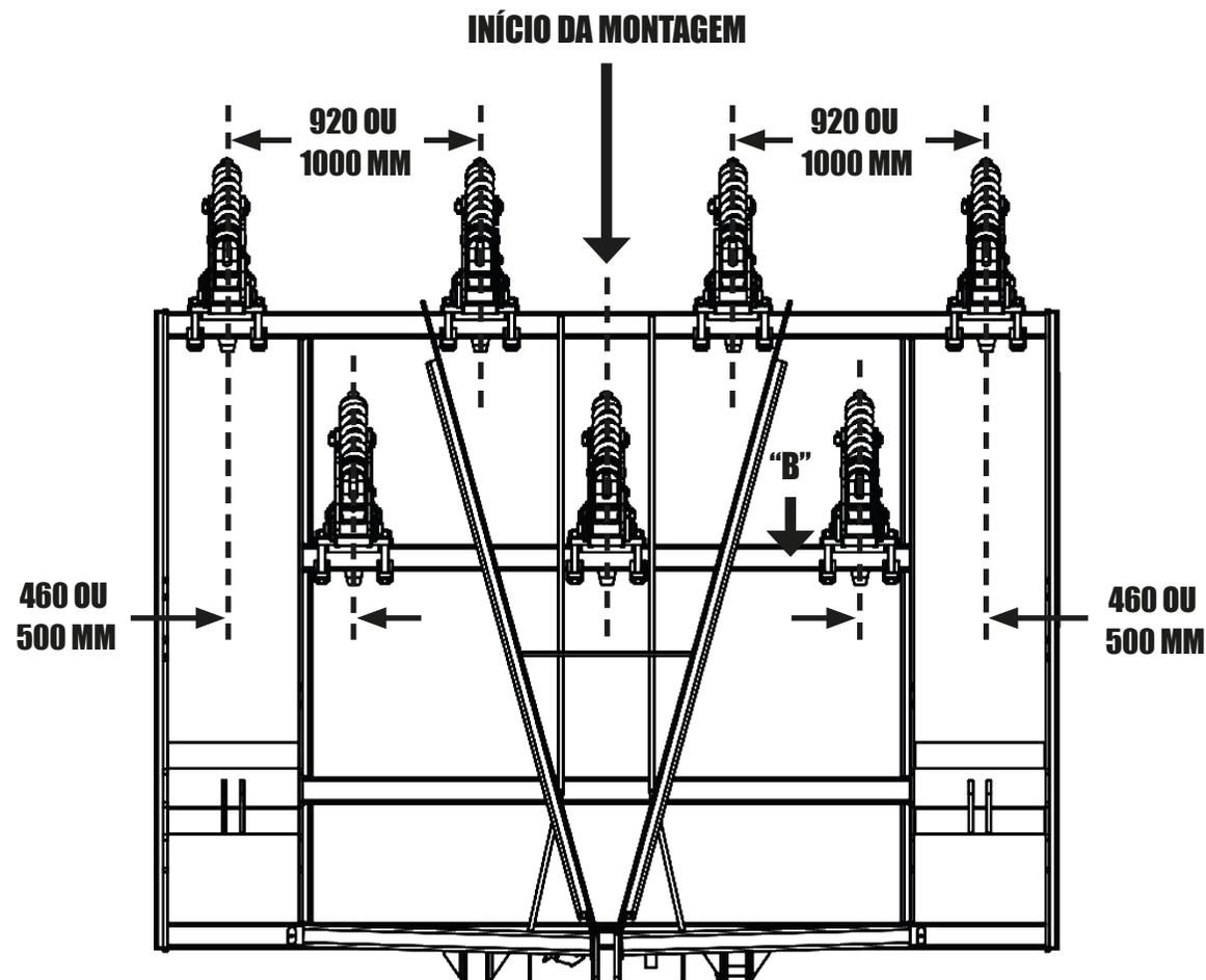
**ATENÇÃO** No SCB-CR 5 hastes, inicie a montagem das hastes pelo centro da barra "A" e no SCB-CR 7 hastes pelo centro da barra "B" indo para as demais.
