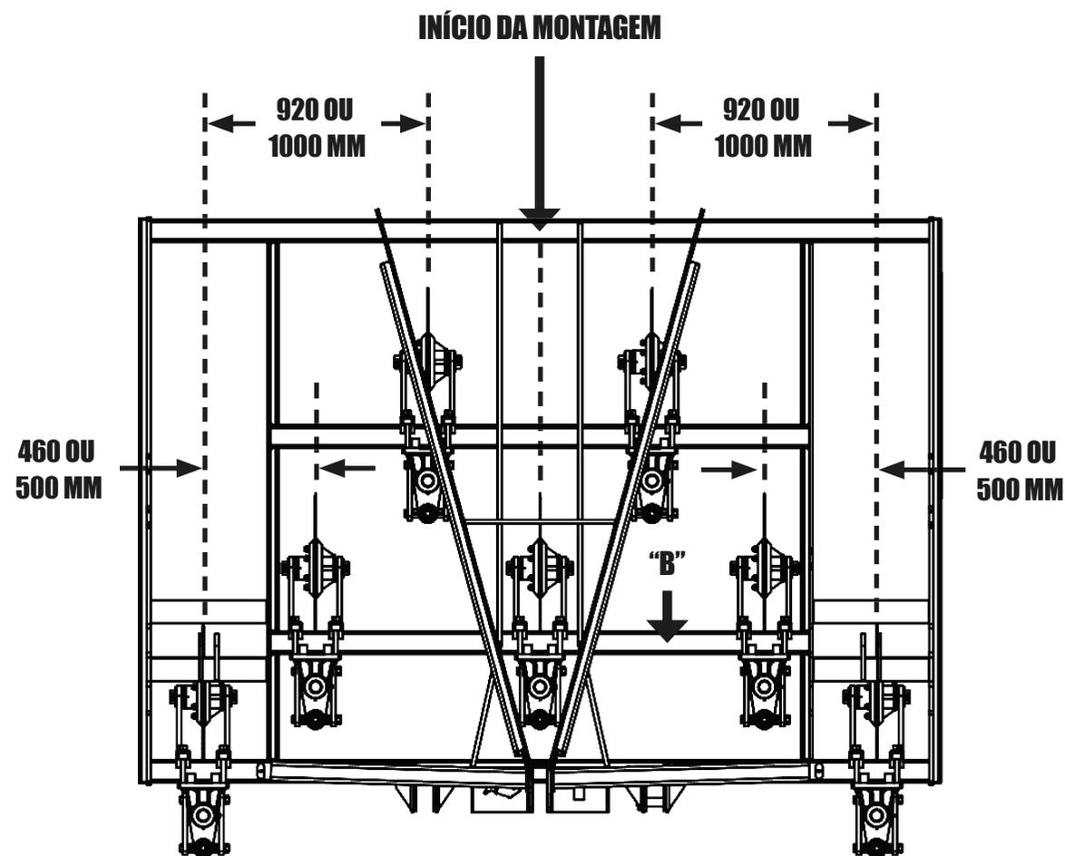
**ATENÇÃO** No SCB-CR 5 hastes, inicie a montagem dos discos pelo centro da barra "A" e no SCB-CR 7 hastes pelo centro da barra "B" indo para as demais.
