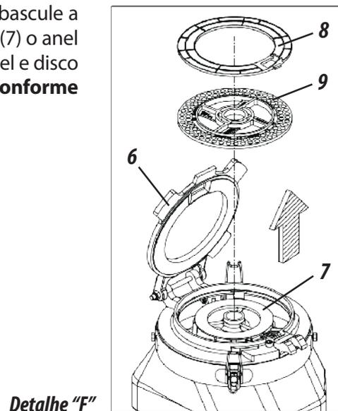
**5º Passo:** Ao efetuar a troca do anel (8) e do disco (9), bascule a base (6) fechando-a. Em seguida, trave as presilhas (5) novamente, **conforme mostra os detalhes "G" e "H"**.
