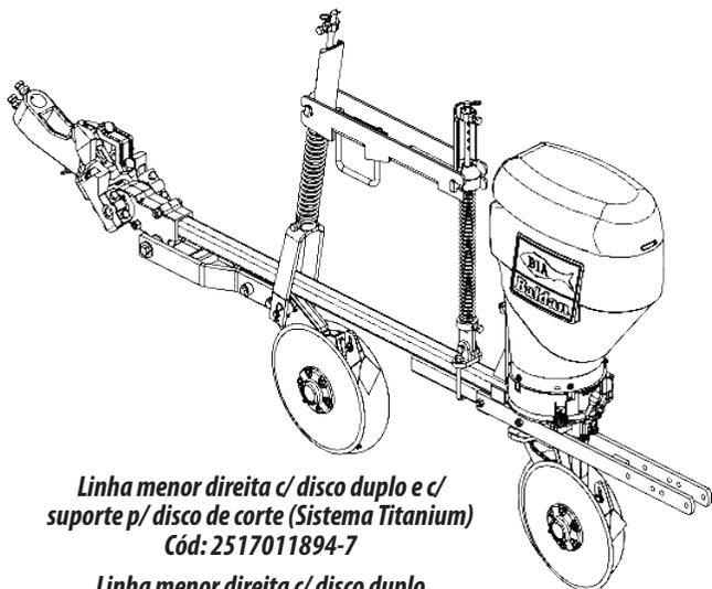
**Linha menor direita c/ disco duplo e c/ suporte p/ disco de corte (Sistema Titanium)**
