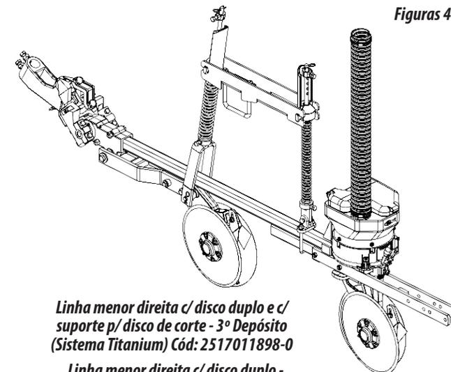
**Linha menor direita c/ disco duplo e c/ suporte p/ disco de corte - 3º Depósito (Sistema Titanium)** Cód: 2517011898-0
