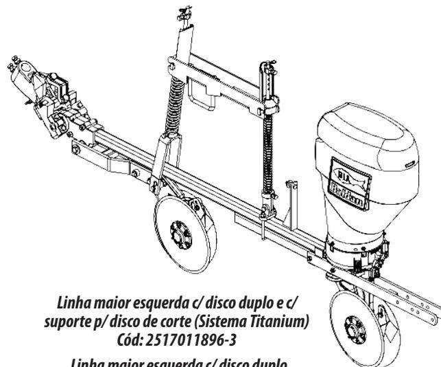
**Linha maior esquerda c/ disco duplo e c/ suporte p/ disco de corte (Sistema Titanium)**
