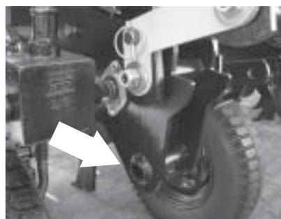
**5º Passo:** Depois coloque o pino no furo (5) travando a base do pantográfico, **conforme mostra a figura 13.**
