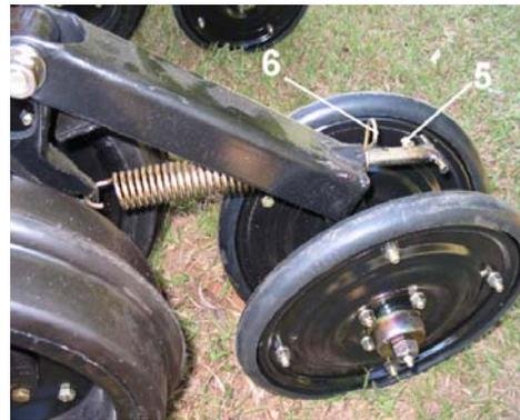
**NOTA:** Se o terreno for de fácil assoreamento ou do tipo que forma camada dura na superfície após as chuvas, retire o conjunto da roda compactadora em “V” e regule as rodas (1) para fechar o sulco.
