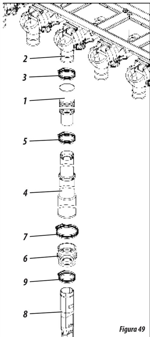
Para conduzir o fertilizante do distribuidor até o solo, encaixe o mangote (1) nas saídas do condutor independente (2) através das presilhas (3). Em seguida, acople o condutor telescópico (4) no mangote (1) fixando através da presilha (5). Depois, acople a união de borracha (6) no condutor telescópico (4) fixando através da presilha (7). Finalize acoplando a bica (8) na união de borracha (6) fixando através da presilha (9), **conforme mostra a figura 49.**
