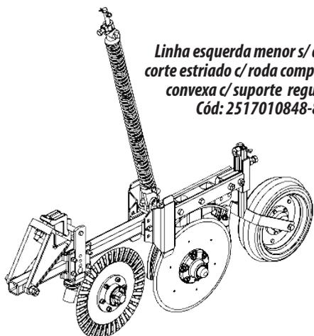
*Linha direita menor c/ disco de corte estriado c/ roda compactadora convexa c/ suporte regulador
