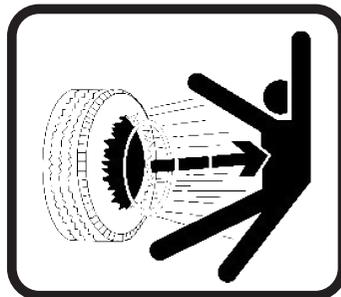
• Jamais solde a roda montada com pneu, o calor pode causar aumento de pressão de ar e provocar a explosão do pneu.
