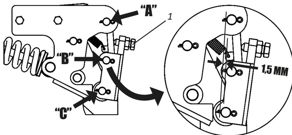
**⚠ ATENÇÃO** Ao proceder a regulagem do parafuso (1), certifique-se que os três pinos (A, B, C) não fiquem no mesmo alinhamento para que o sistema não fique rígido (sem desarme). A distância mínima é de 1,5 mm.
