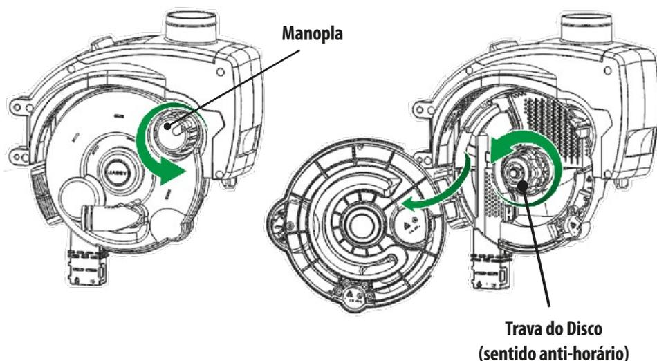
**03** - Monte o conjunto de disco com o **Singulador** (Organizadores) voltado para dentro do dosador. Após posicionar o conjunto, gire a **trava do disco** no **sentido horário** para travar o conjunto.
