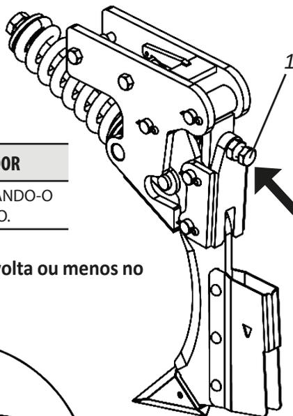
**⚠ ATENÇÃO** Essa regulagem é mínima, tendo assim com volta ou menos no parafuso a regulagem ideal.
