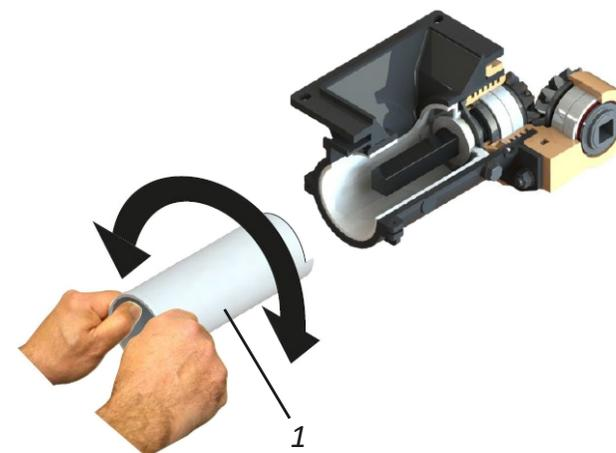
**OBSERVAÇÃO** | O tubo de manutenção (1) apresenta um ângulo de corte na extremidade para facilitar esta operação.
