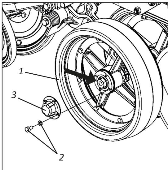
Para lubrificar as rodas compactadoras (1), solte os parafusos e arruelas (2), retire a calota (3) e introduza graxa nova. Recoloque a calota (3) nas rodas compactadoras (1) e fixe-a com os parafusos e arruelas (2).
