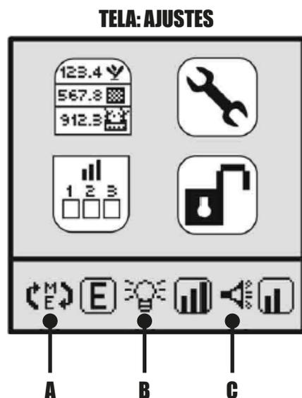
**01** - Pressione
