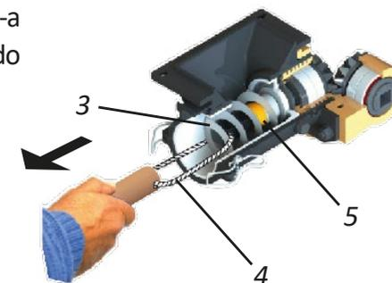
**03** - Após a limpeza, recoloca a mola sem-fim (3), juntamente com o anel trava (5), através do tubo fixador (4) observando que a mola sem-fim (3) e o anel trava (5) fiquem bem posicionados na base do eixo (6).
