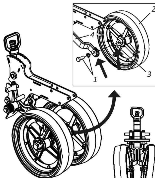
**01** - Solte os parafusos e arruelas (1), retire a roda (2), ajuste o ponto de regulagem da roda (3) na regulagem do eixo do suporte da roda (4), depois fixe novamente a roda (2) com as arruelas e parafusos (1).
