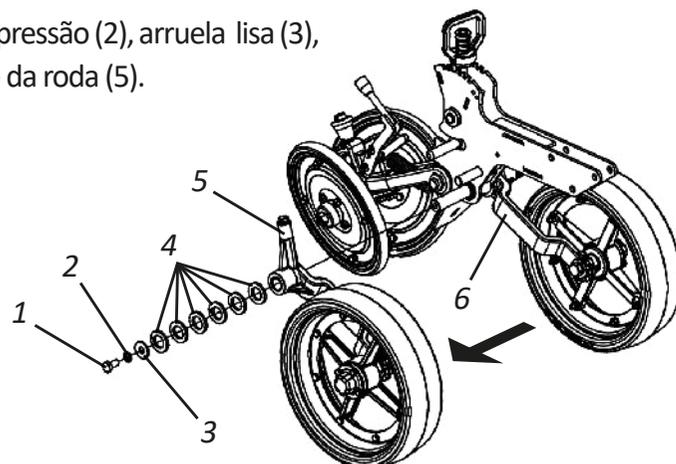
**02** - Em seguida, faça o processo inverso, colocando primeiramente os 6 calços (4), depois o suporte da roda (5) e finalize colocando a arruela lisa (3), arruela de pressão (2) e o parafuso (1) apertando-o.
