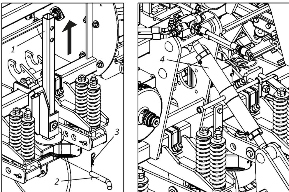
**02** - Com a semeadora abaixada, nivele-a através do regulador (4) do cabeçalho de engate.
