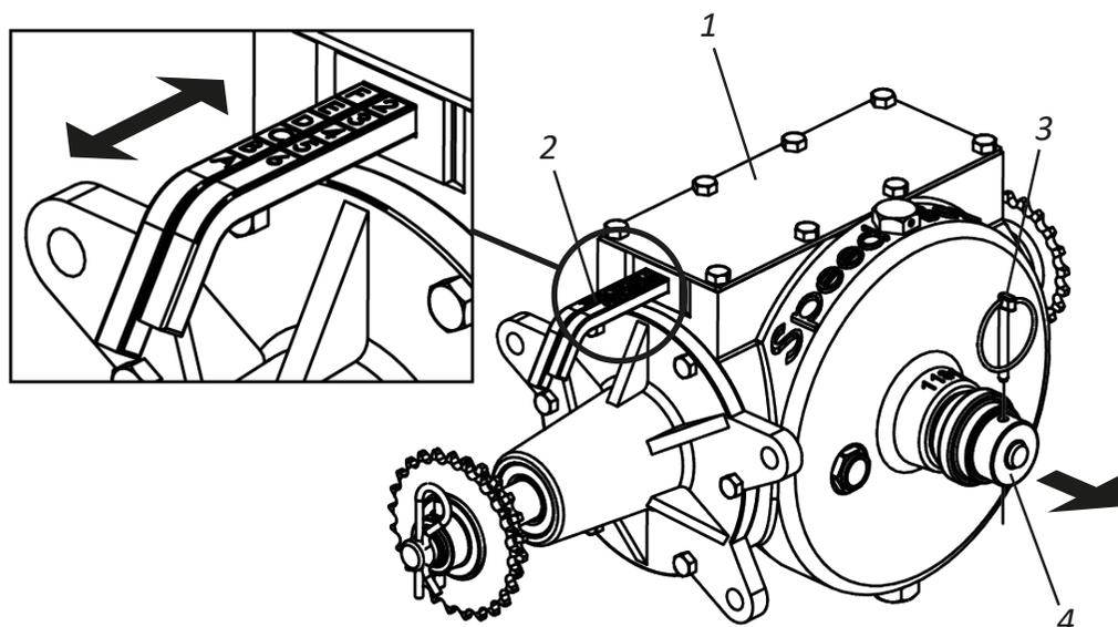
**02** - Para movimentar as alavancas, retire a trava (3), puxe a manopla (4), em seguida, regule as alavancas conforme exemplo acima. Ao terminar a combinação, retorne a manopla (4) e recoloca a trava (3).
