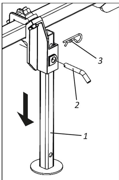
**02** - Em seguida, abaixe os suportes de apoio (1) na parte frontal da semeadora e fixe-os com os pinos (2) e travas (3).
