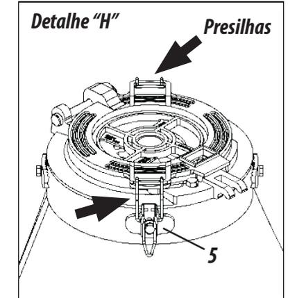
**4º Passo:** Depois, solte as presilhas (5), bascule a base (6) e retire da base do distribuidor (7) o anel (8) e o disco (9), substituindo-os pelo anel e disco adequados a cultura que irá trabalhar, **conforme mostra os detalhes "E" e "F"**.
