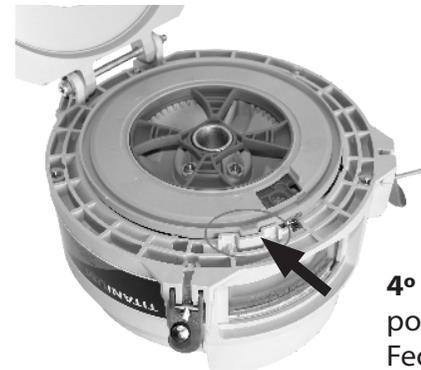
**4º Passo:** Encaixe o anel adaptador no disco obedecendo o posicionamento. Feche a contra base, trave o sistema.
