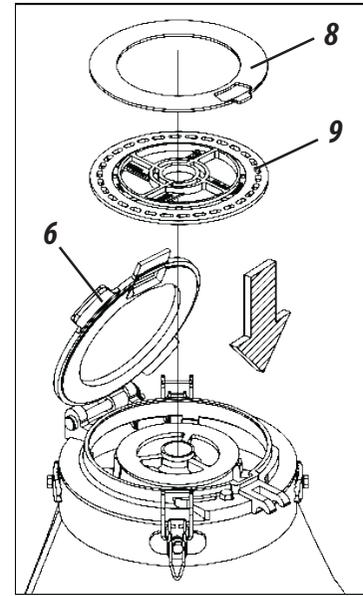
**5º Passo:** Ao efetuar a troca do anel (8) e do disco (9), bascule a base (6) fechando-a. Em seguida, trave as presilhas (5) novamente, **conforme mostra os detalhes "G" e "H"**.
