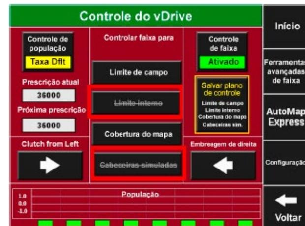
O operador pode selecionar “Limite de campo” ou “Limite interno” para indicar que o operador deseja que as seções sejam desligadas fora do limite de campo ou dentro do limite interno. O operador pode selecionar “Cobertura do mapa” para indicar que deseja que as embreagens sejam desligadas ao cruzar uma área já plantada. A seleção de “Cabeceiras simuladas” controla as embreagens para um deslocamento a partir dos limites de campo, permitindo que as cabeceiras sejam plantadas por último.
