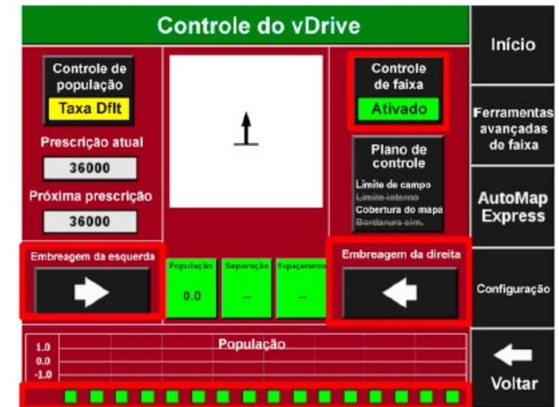
Quando o Controle de faixa está no “Modo manual”, o operador tem dois métodos de controle manual. O operador pode desligar as seções, começando em uma extremidade da plantadeira e percorrer a plantadeira pressionando as setas “Embreamento da esquerda” ou “Embreamento da direita”. Cada vez que o operador pressiona uma seta, desliga ou liga uma seção. Veja ao lado.
