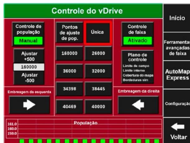
Para alterar qualquer dos pontos de ajuste de população, selecione "Pontos de ajuste de pop.". O operador pode, então, determinar os pontos de ajuste da população. Veja a figura ao lado.
