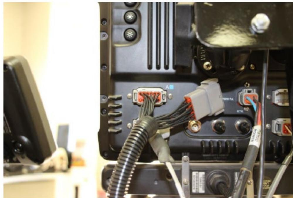
Conecte o GPS com etiqueta de 4 pinos no chicote de trator universal 725499 da Precision Planting (conexão com a Unidade de monitor) no GPS com etiqueta de 4 pinos.
