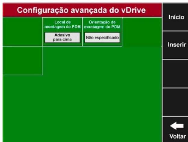
Selecione “Local de montagem do PDM”. Determine se o PDM será montado com o adesivo dele virado para cima ou para baixo. Veja a figura ao lado.
