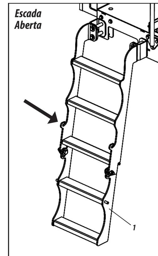
Posição para abastecimento ou manutenção dos depósitos
