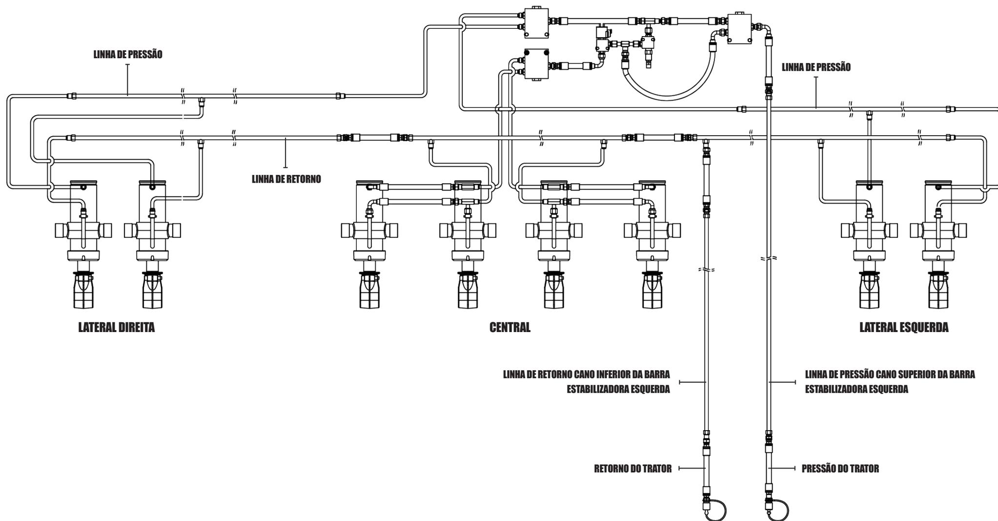
**MONTAGEM DO SISTEMA HIDRÁULICO DE ABERTURA E NIVELAMENTO - IGUAL OU ABAIXO DE 27 LINHAS**
