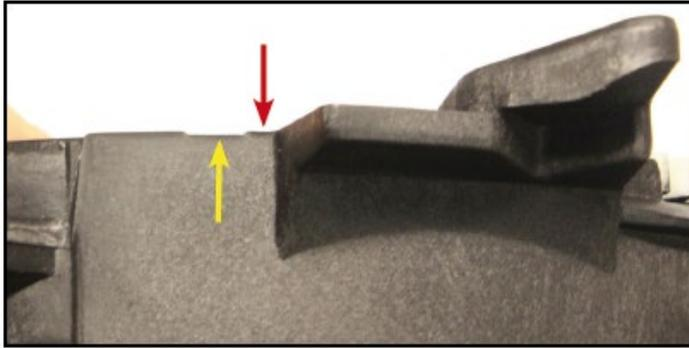
• Para verificar, mantenha o disco nivelado contra a placa da unidade central. O número de calços necessários é determinado pelo acréscimo ou remoção de calços do disco entre os planos inferior e superior. O disco do medidor precisa ser verificado em pelo menos duas posições para determinar a contagem final de calços. Gire 180° para verificar.
