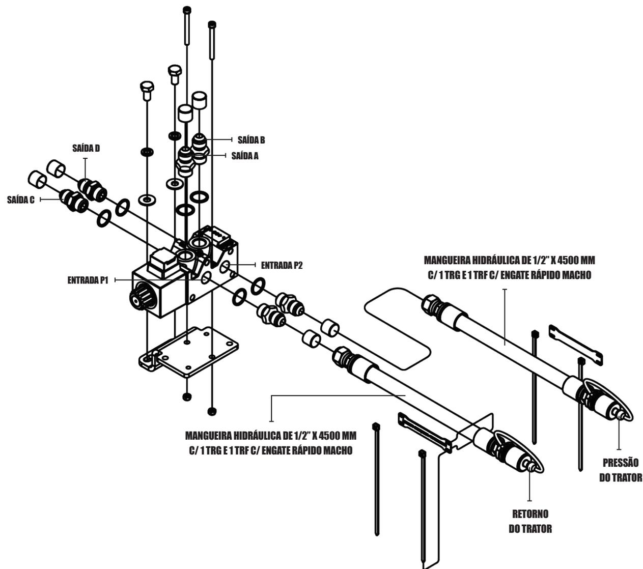
**MONTAGEM SISTEMA HIDRÁULICO CENTRAL PARA ABERTURA E FECHAMENTO - ACIMA DE 34 LINHAS**
