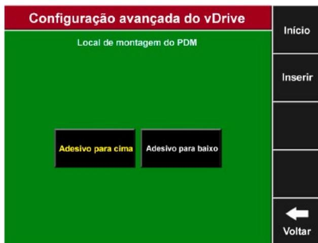
6.3 Selecione “Orientação de montagem do PDM”. Determine a orientação dos fusíveis. A referência da orientação se baseia no operador sentado na cabine. Veja a figura abaixo.
