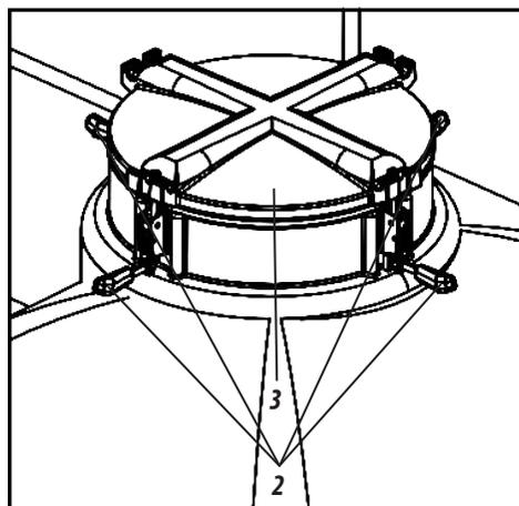
2- Em seguida, retire a tampa (3) do depósito (1) e coloque-a no suporte de apoio (4).
