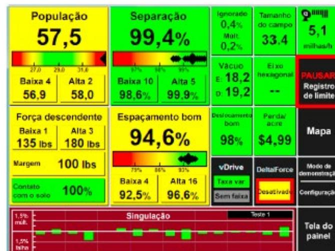
Depois que o limite fica dentro de uma largura de deslocamento do ponto de partida, o operador será solicitado a fechar o limite ou continuar registrando. Isso conclui o registro do limite de campo.
