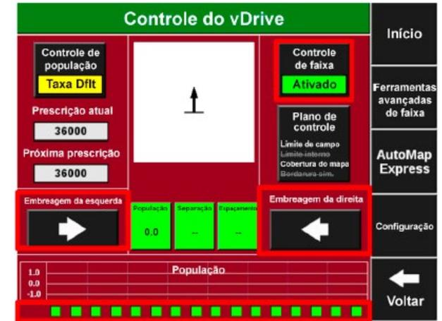
Quando o Controle de faixa está no “Modo manual”, o operador tem dois métodos de controle manual. O operador pode desligar as seções, começando em uma extremidade da plantadeira e percorrer a plantadeira pressionando as setas “Embreagem da esquerda” ou “Embreagem da direita”. Cada vez que o operador pressiona uma seta, desliga ou liga uma seção. Veja ao lado.
