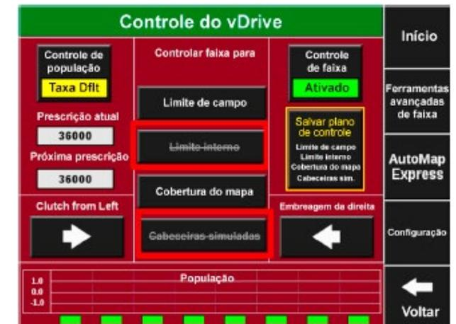
O operador pode selecionar “Limite de campo” ou “Limite interno” para indicar que o operador deseja que as seções sejam desligadas fora do limite de campo ou dentro do limite interno. O operador pode selecionar “Cobertura do mapa” para indicar que deseja que as embreagens sejam desligadas ao cruzar uma área já plantada. A seleção de “Cabeceiras simuladas” controla as embreagens para um deslocamento a partir dos limites de campo, permitindo que as cabeceiras sejam plantadas por último.
