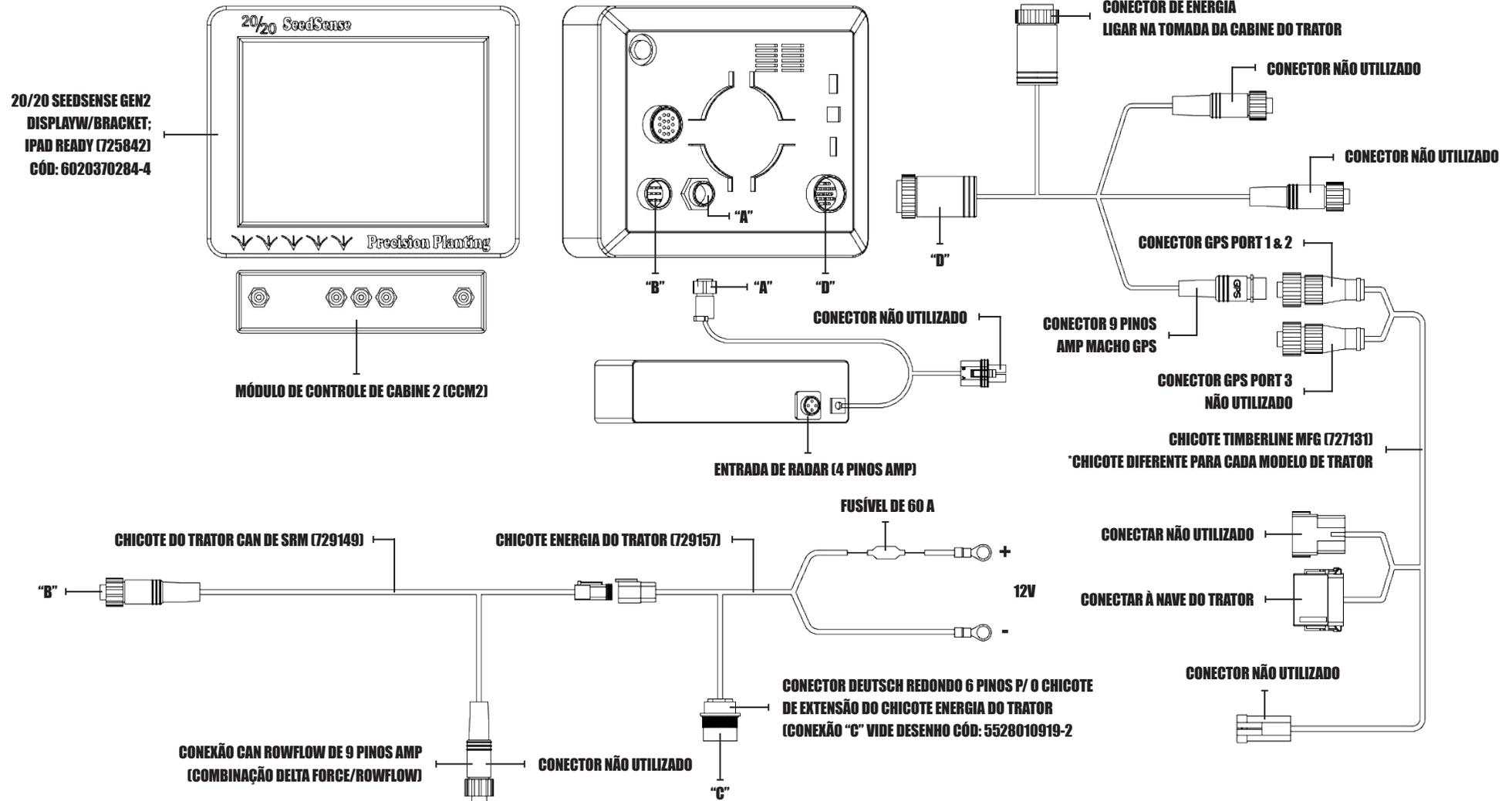
**MONTAGEM SISTEMA ELETRÔNICO PRECISION PLANTING - LIGAÇÃO NA MÁQUINA**
