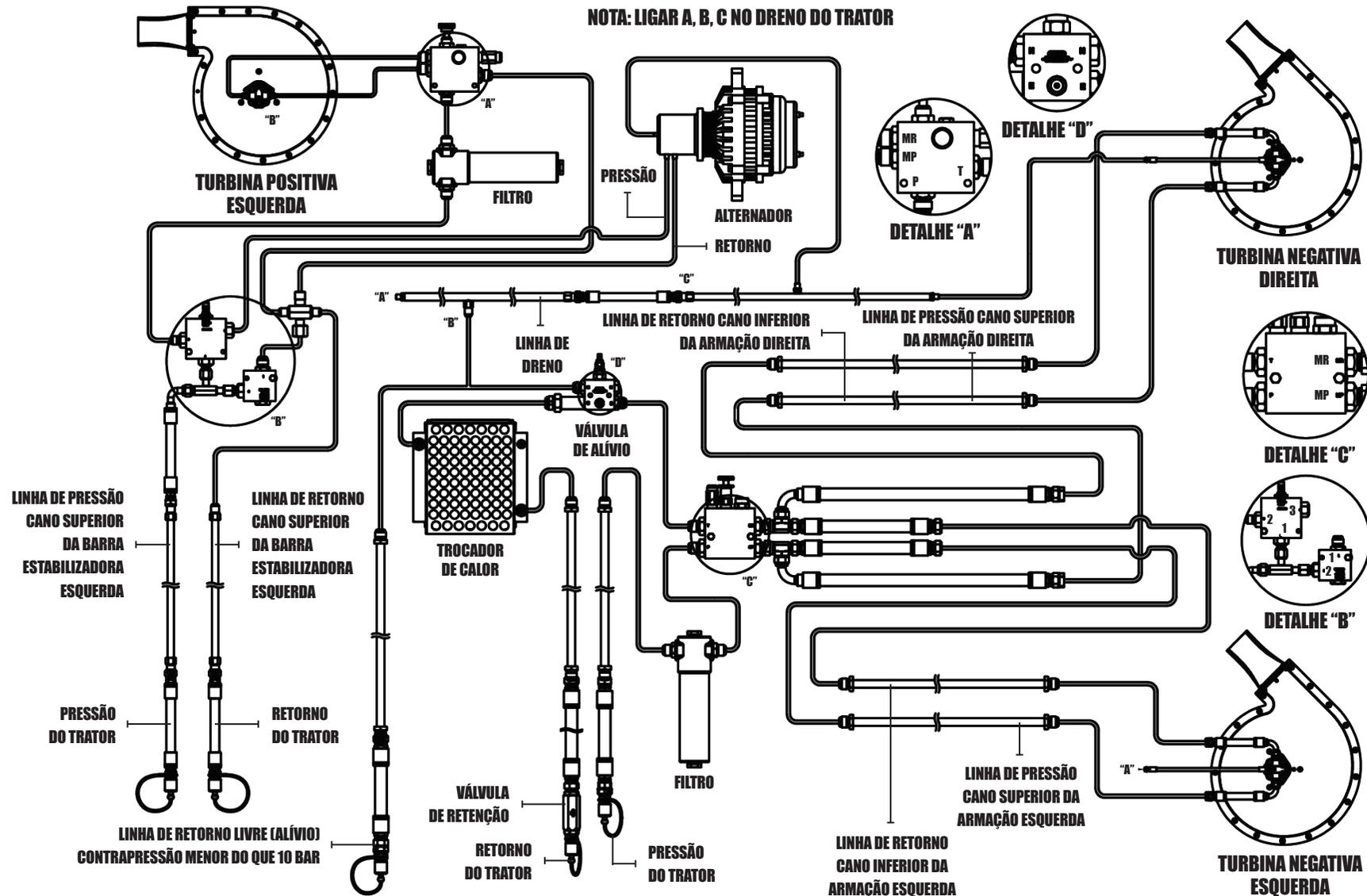
**MONTAGEM DO SISTEMA HIDRÁULICO DAS TURBINAS E ALTERNADOR - ACIMA DE 34 LINHAS**
