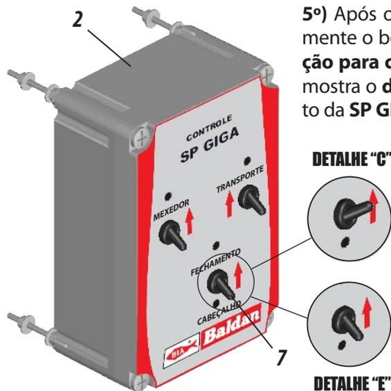
5º) Após o ALINHAMENTO, acione novamente o botão (7) do painel (2) na **(posição para cima) FECHAMENTO**, conforme mostra o **detalhe "C"** e faça o fechamento da SP GIGA MAX.
