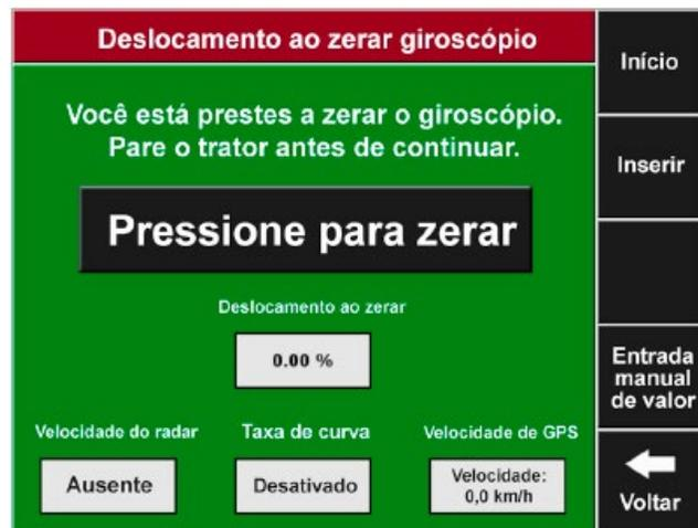
3.21 Deslocamento do giroscópio bem-sucedido. Veja a figura abaixo.
