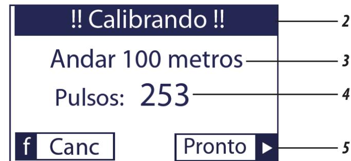
Ao iniciar a calibração do sensor (2), a máquina deve ser deslocada por exatos 100 metros (3) e parar.
