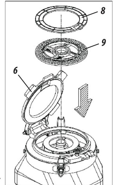
**4º Passo:** Depois, solte as presilhas (5), bascule a base (6) e retire da base do distribuidor (7) o anel (8) e o disco (9), substituindo-os pelo anel e disco adequado a cultura que irá trabalhar, **conforme mostra os detalhes "E" e "F"**.
