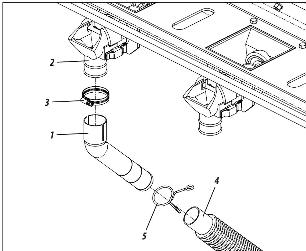
O sistema fertisystem de distribuição, possui saídas de segurança que garantem o bom funcionamento do sistema sem danificá-lo. Em caso de entupimento da mangueira e do dosador, proceda a limpeza do dosador até o final do mangote
