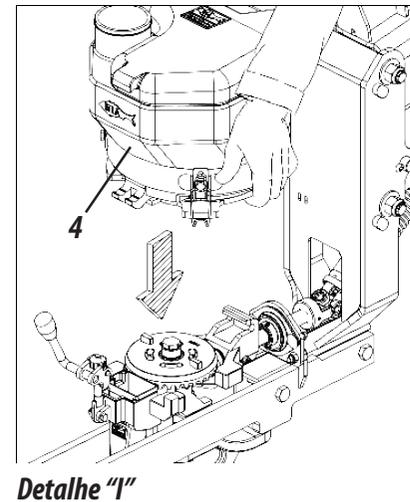
**6º Passo:** Finalize recolocando a caixa de semente (4) na linha e rearme a trava (3), fixando a alavanca (1) através do pino (2), **conforme mostra os detalhes "I" e "J"**.
