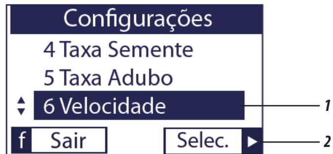
Ao clicar em 'Selec.' ► (2) na configuração 'Velocidade' (1) será apresentado por quantas horas (4) a máquina esteve trabalhando acima da velocidade limite (3).
