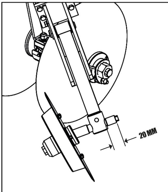
**⚠ ATENÇÃO** | Não opere o TACR com o eixo montado a menos de 20 mm de distância do suporte.
