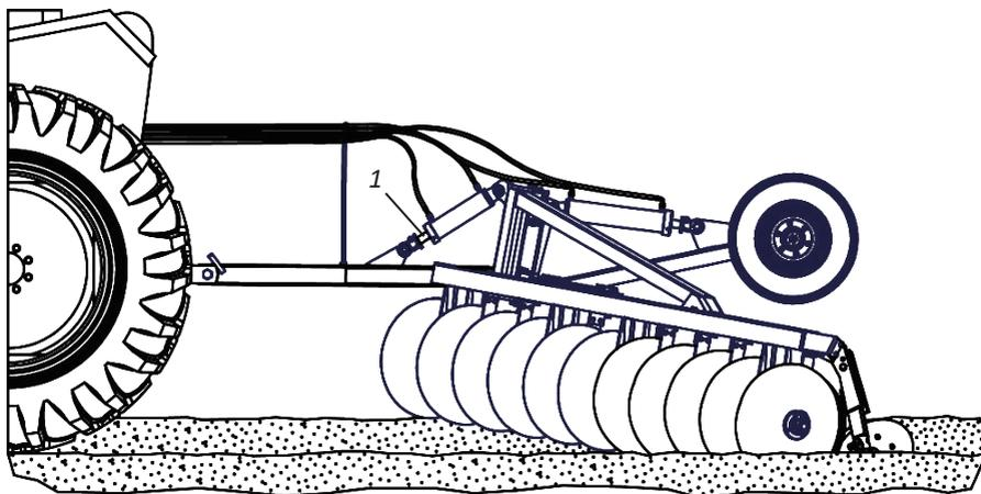
Nas demais passadas, o cilindro hidráulico (1) deverá ser acionado gradativamente até se concluir o terraceamento, conforme mostra a figura abaixo.
