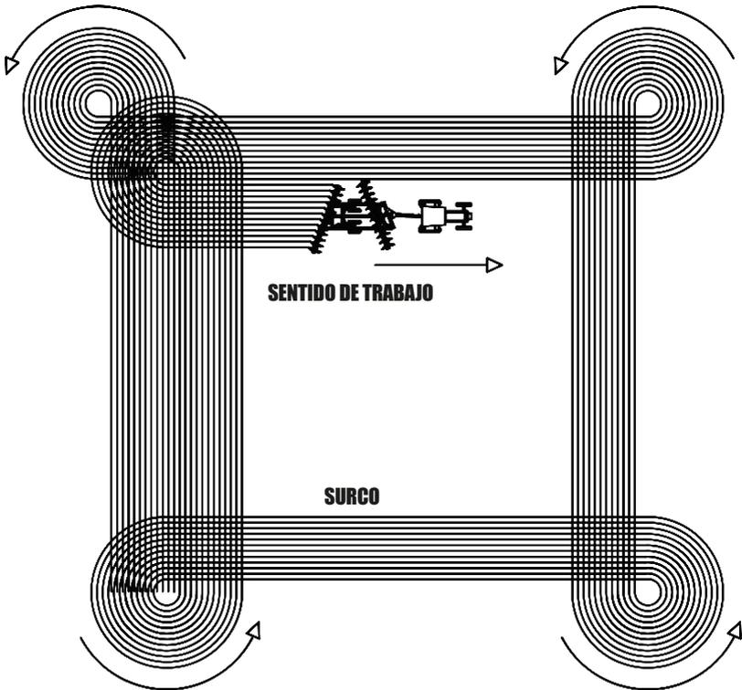
**! IMPORTANTE** Intente conducir el tractor para obtener un buen rendimiento entre las pasadas de la GSPCR-E. Evitar la formación de crestas o franjas sin rastrillar.
