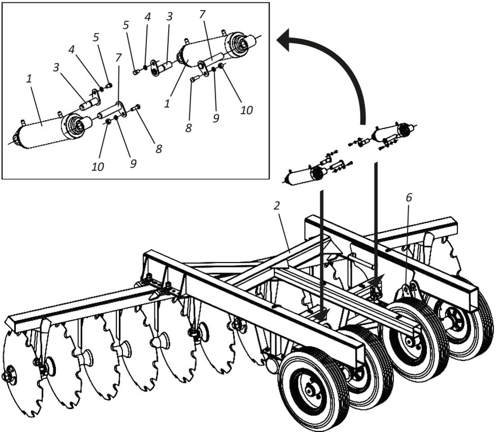
**⚠ ATENCIÓN** | Al montar los cilindros hidráulicos (1), sus terminales deben colocarse hacia arriba.
