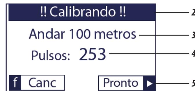
Al iniciar la calibración del sensor (2), la máquina debe moverse exactamente 100 metros (3) y detenerse.
