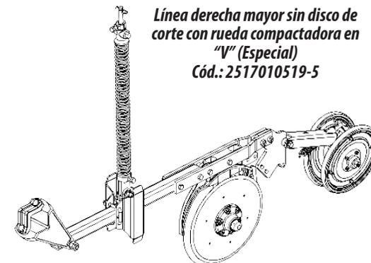
*Línea derecha mayor sin disco de corte con rueda compactadora en "V" (Especial)
